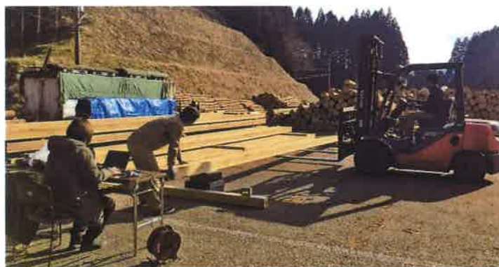
写真 1-4 手作業による含水率測定とヤング係数測定風景
