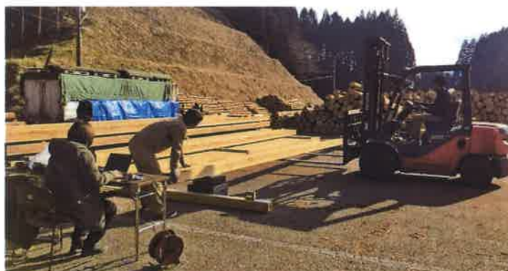
写真 1-4 手作業による含水率測定とヤング係数測定風景
