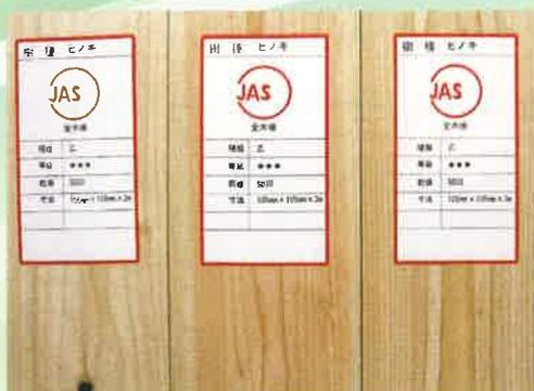
目視等級区分 人工乾燥処理構造用製材 (乙種)
