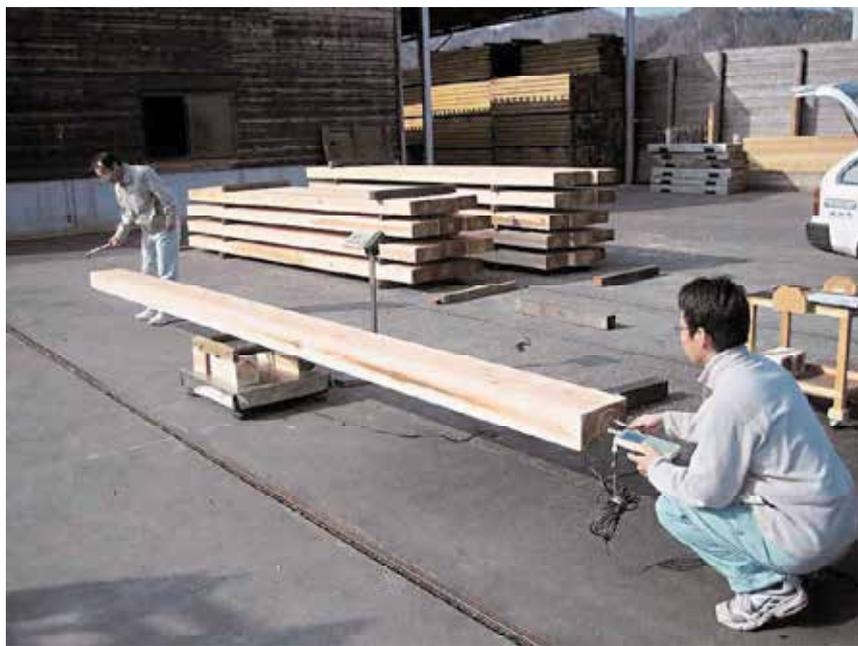
写真6-2 縦振動法による動的ヤング係数の測定様子
