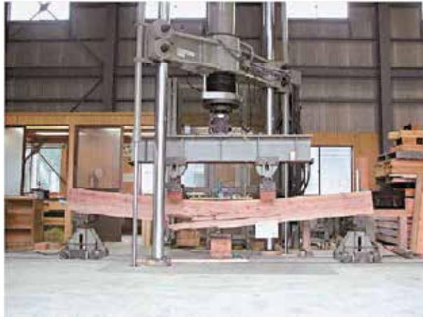
写真6-3 木材の実大強度試験機によるスギ平角材の曲げ強度試験（林業研究部）
