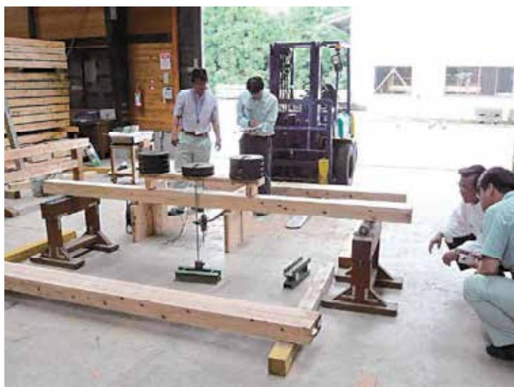
写真6-1 曲げヤング係数の測定の様子
