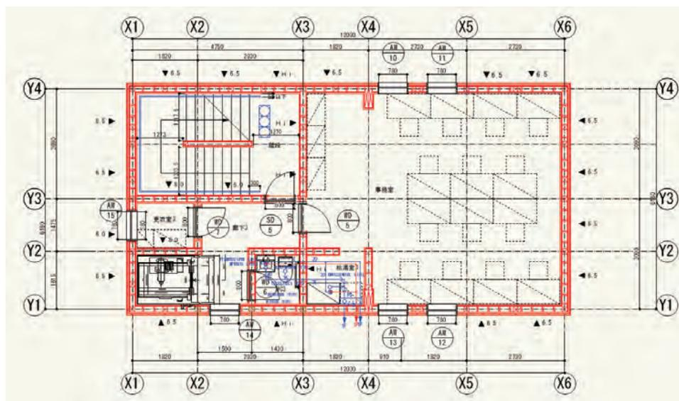
図 1-7 診療所 耐火木造4階 3階平面図
