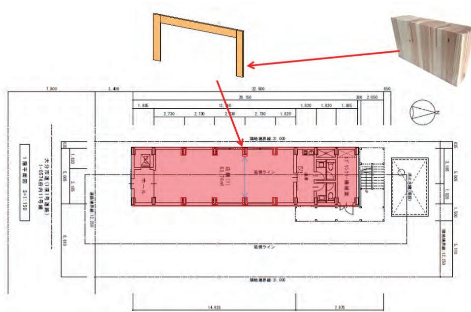
図 1-6 4階木造ビル1階平面図
